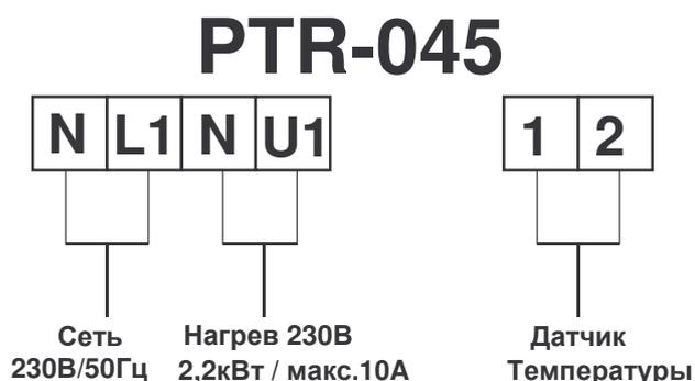
Кабель датчика температуры можно удлинить экранированным проводом ( $2 \times 0,75 \text{мм}^2$ ) до 10 м. Экран присоединить к клемме 1. Непременно прокладывайте проводку водостойчиво. **Избегать прокладку кабеля датчика вблизи с силовыми кабелями из-за возможных наводящихся помех.**
