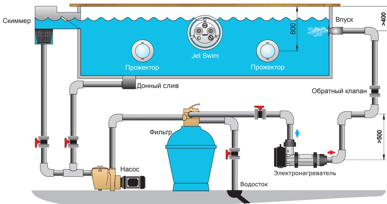
1. После завершения прокладки труб, подсоедините нагреватель к сети электропитания согласно электрической схеме подключения.
