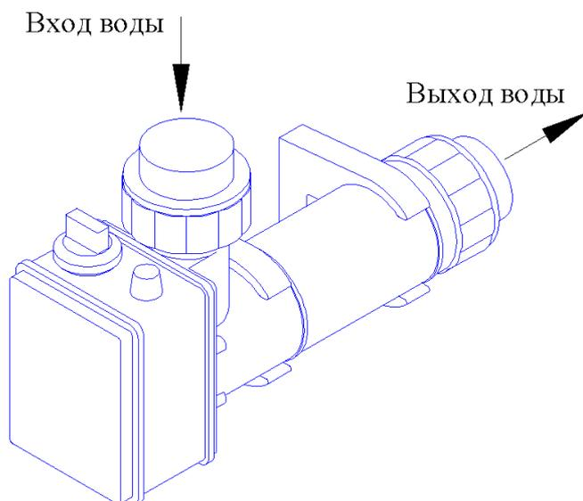
Основной задачей электронагревателя является подогрев воды. Электронагреватель компенсирует теплопотери при восполнении объема свежей подпиточной водой и потерь, возникающих при её испарении с поверхности зеркала воды, в коммуникациях и оборудовании системы обратного водоснабжения.
