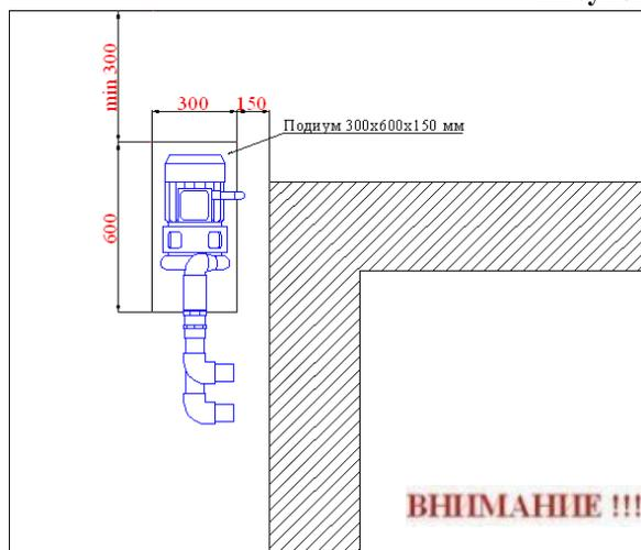
В техническом помещении изготовьте подиум для насоса (см. рис 25).
