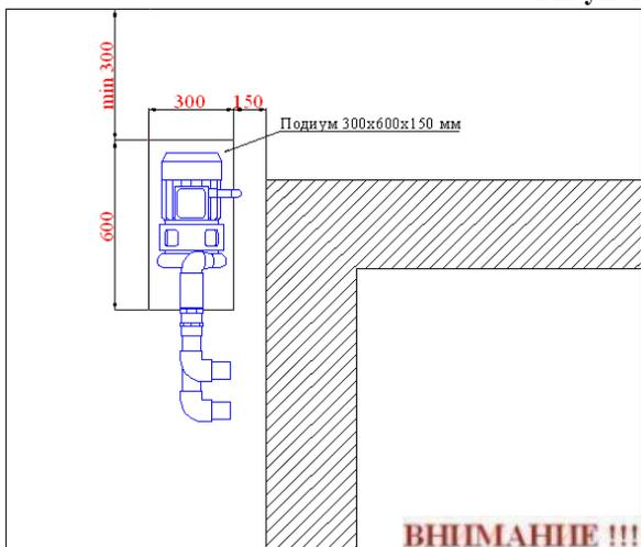
В техническом помещении изготовьте подиум для насоса (см. рис 24).
