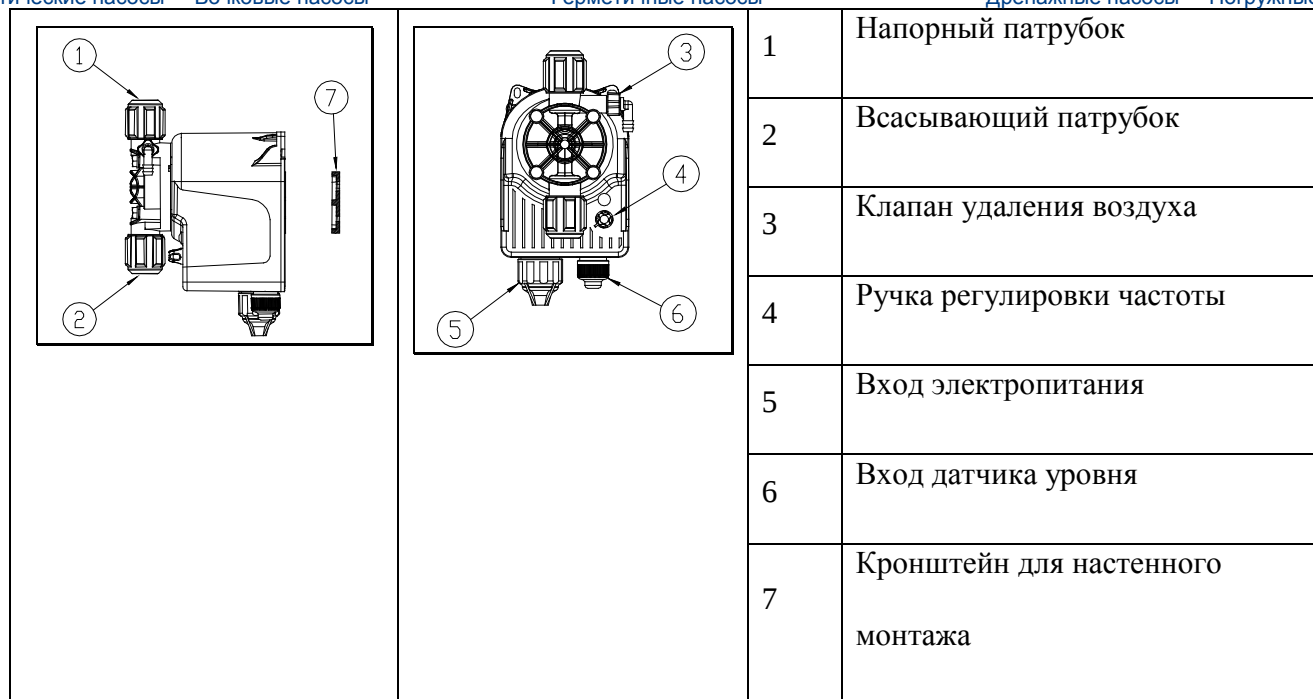
Рис. 10. Составные части насоса
