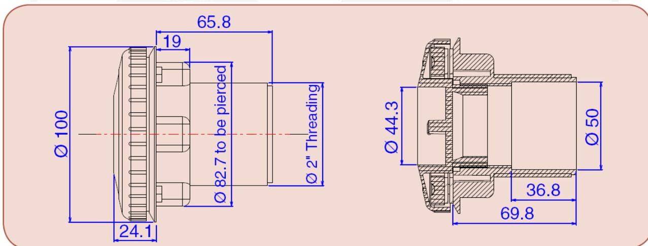
Схема монтажа закладной для пылесоса со стеновым проходом
