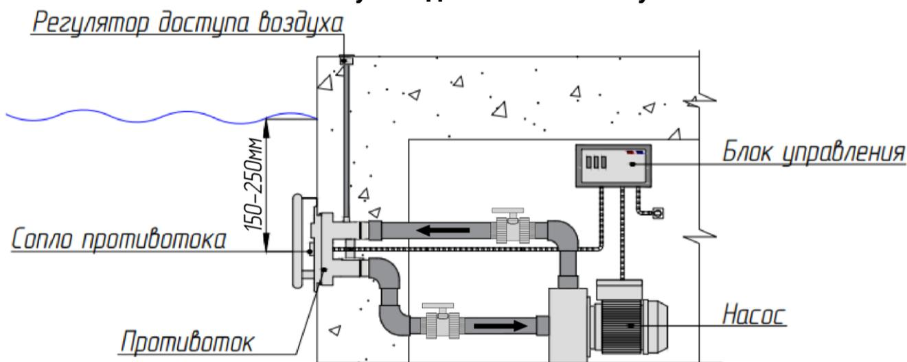
Циркуляционный насос, блок управления и трубопроводная арматура, необходимые для оснащения узла противотока, в комплект поставки не входят и приобретаются отдельно.
