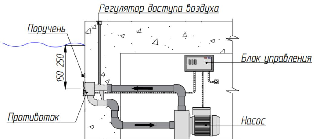
Поручень, циркуляционный насос, блок управления и трубопроводная арматура, необходимые для оснащения узла противотока, в комплект поставки не входят и приобретаются отдельно.
