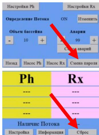
Сброс настроек на стандартные, а также сброс пароля – доступен после нажатия кнопки **СБРОС** на главном экране устройства – 15 раз подряд.
