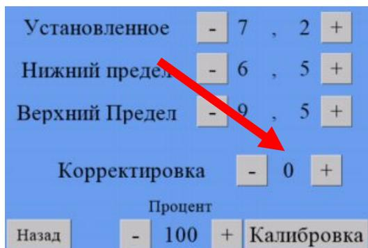
**Коррекция Ph** = (значение по фотометру) – (значение Ph по прибору)
