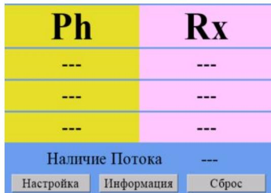
На дисплее устройства, имеется информация по показателям Ph Rx воды плавательного бассейна
