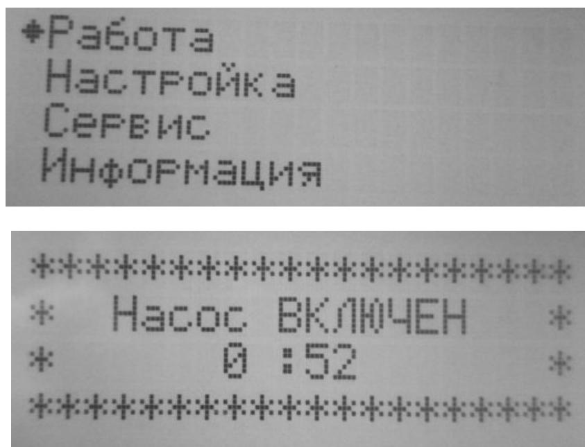
В связи с отключением автоматики защиты, использовать данный режим необходимо с осторожностью. Следите за наличием воды в насосе фильтровальной установки. В случае ее отсутствия нужно немедленно выключить панель управления.
