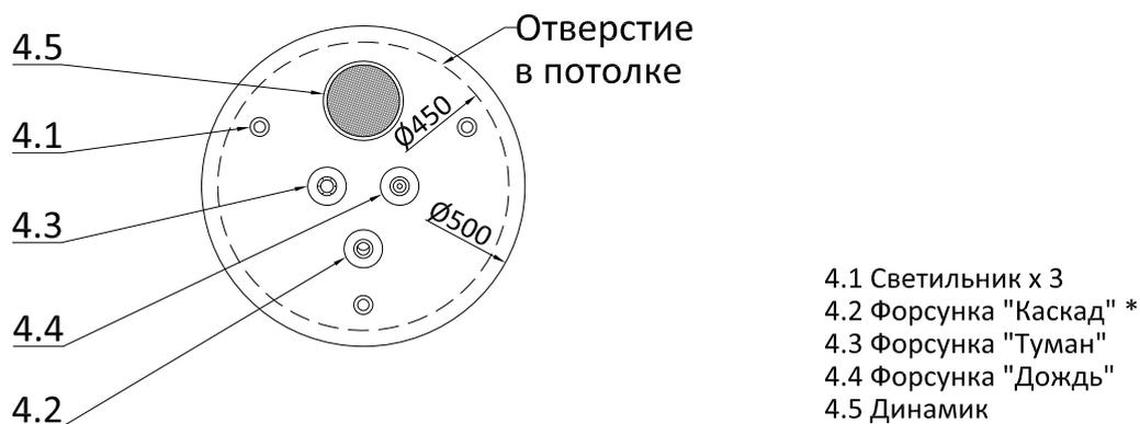
\* при монтаже ориентировать направление работы форсунки "каскад" в направлении от входа в кабину.
