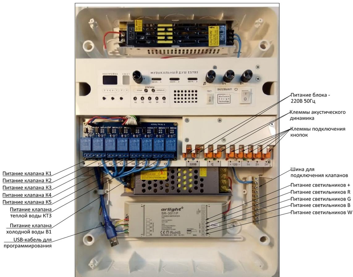
Для ввода проводов в блок управления прорежьте отверстия в нижней части корпуса блока управления.
