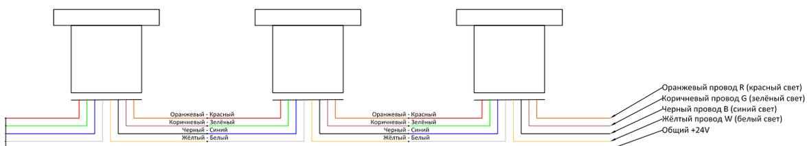
Подключение клапанов к пульту управления выполнить в соответствии со схемой
