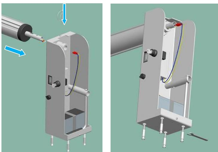
3. Закрепите рукоятку ручного привода (опционально) или подключите внутривальный двигатель
