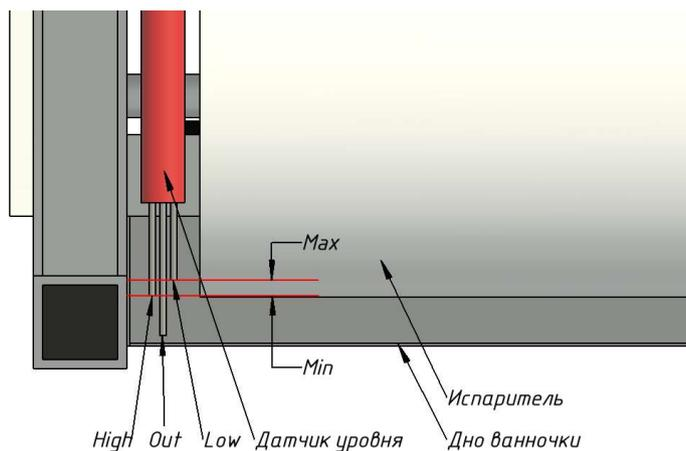
**!** Для избежания существенного намораживания льда на торцах испарителя не рекомендуется погружать испаритель в воду более чем на 5 мм. Настройка положения датчика уровня воды производится на производстве. В случае необходимости положение датчика можно скорректировать, переместив его в креплении датчика.
