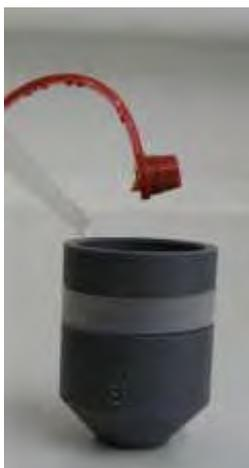
Открутите мембранный стакан со стержня электрода. Поставьте мембранный стакан на чистую поверхность.
