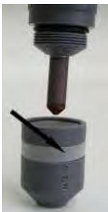
Для этого сдвиньте прозрачное уплотнительное кольцо (см.рис.4), для освобождения выпускного отверстия - отдушины.
