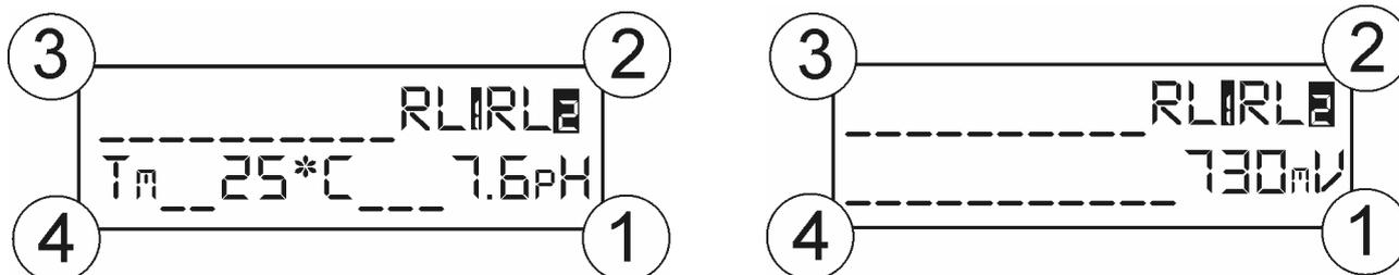
**Зона 1** = отображение измеренных значений pH или Redox
