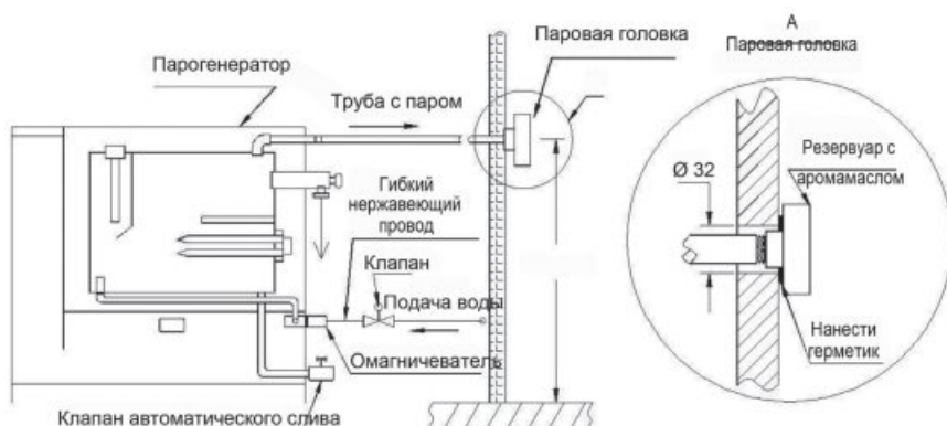
Рисунок 7. Схема установки труб
