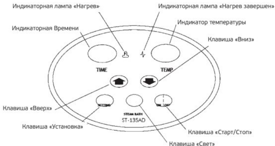
Рисунок 3. Указания по установке контроллера температуры ST-135AD
