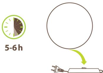
Подключите зарядное устройство. Полностью зарядите аккумулятор светильника, поместив последний на зарядное устройство не менее чем на 6 часов.
