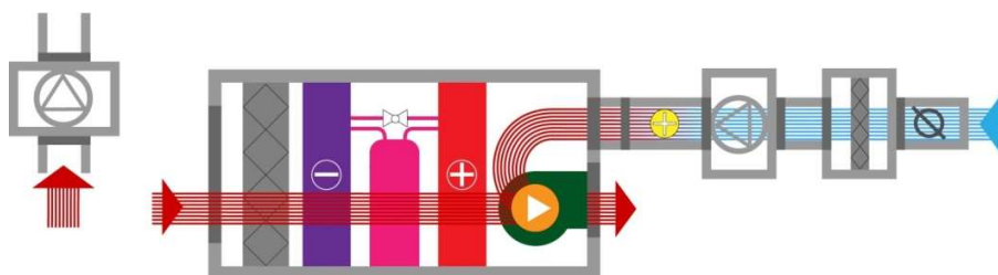
Схема осушителя с подмесом и подогревом свежего воздуха* (подключен воздушный клапан, электрический или водяной нагреватель в линии подмеса свежего воздуха, приточный и вытяжной вентилятор)
