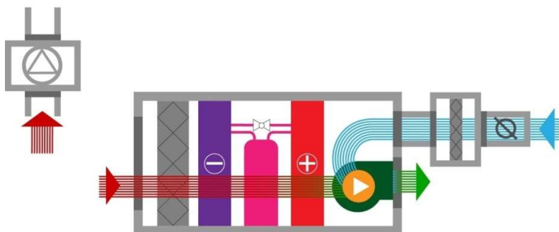
Схема осушителя с подмесом свежего воздуха (подключен воздушный клапан, приточный и вытяжной вентилятор)
