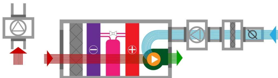
Схема осушителя с подмесом свежего воздуха (подключен воздушный клапан, приточный и вытяжной вентилятор)
