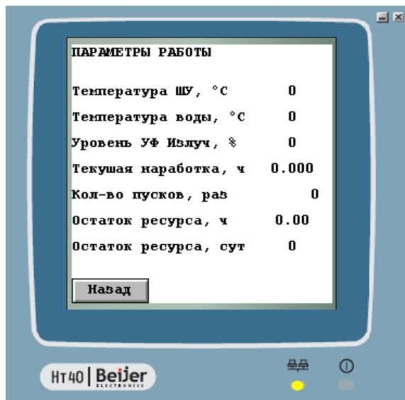
Окно Параметры содержит информацию о работе установки, температуры воды в установке и воздуха в ШУ, данные о ресурсе УФ ламп и УФ излучении.
