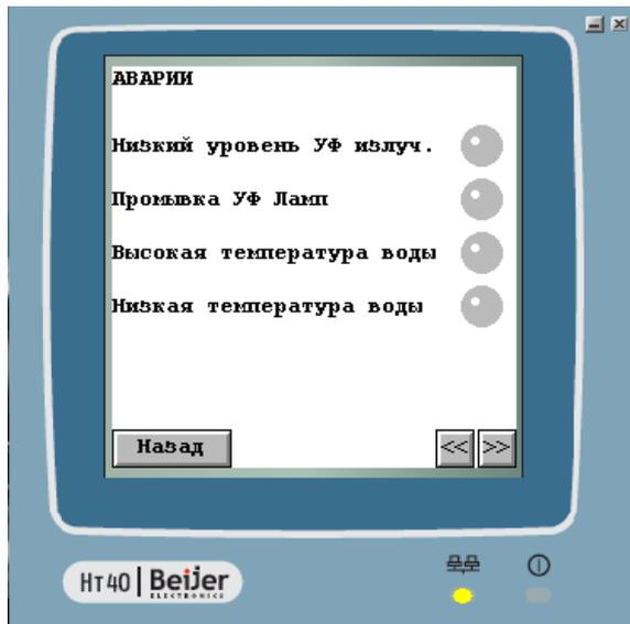
Окно Аварии содержит список аварийных сигналов и индикатор состояния каждого из них.
