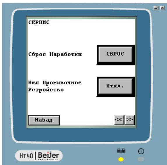
Помимо контактной информации Сервисной Службы, раздел Сервис содержит кнопки сброса счетчика наработки и включения/отключения насоса Промывочного Устройства. Для предотвращения несанкционированного сброса, кнопка «Сброс» защищена паролем.
