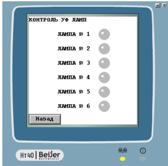
Окно Контроль отображает состояние каждой УФ лампы.
