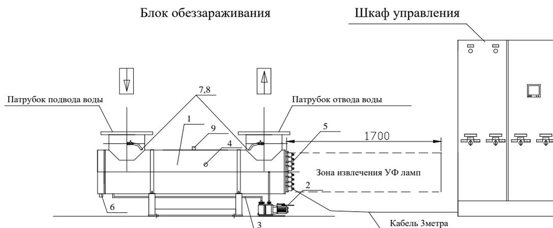
1-БЛОК ОБЕЗЗАРАЖИВАНИЯ; 2-ПРОМЫВОЧНОЕ УСТРОЙСТВО; 3-ШЛАНГ ПУ;
