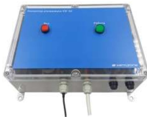
Внешний вид УЗ-преобразователя и источника напряжения
