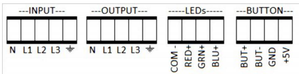
**INPUT** – подключение в сеть. При подключении однофазной нагрузки используйте клеммы N L1, а при подключении трехфазной N L1 L2 L3. Подключение нулевого провода обязательно.
