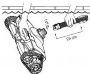
Выключите насос. Заполните шланг водой, отсоедините тестер потока. Погрузите корпус пылесоса и заполните его водой. Подключите шланг к корпусу пылесоса с помощью быстрого разъема. Дайте пылесосу опуститься на дно бассейна. Включите насос в бассейне, далее начнется уборка.
